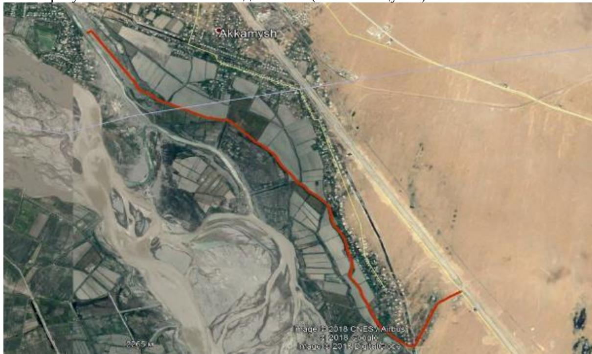
**Рисунок 2.1:** Трассировка Реконструкции канала Ак-Камыш
